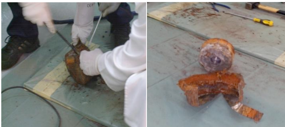
Slika 2. Vađenje radioaktivnog izvora iz gromobrana
