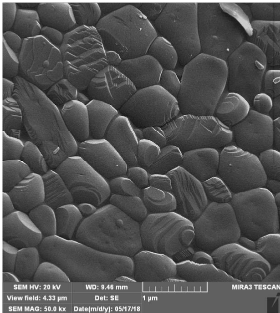
Слика 27. Скенирајуће електронске микрографије прахова прекурсора допитраног мулита са 6 мас% \text{Fe}_2\text{O}_3 , термички третираног на 800\text{ }^\circ\text{C} у току 4 сата
