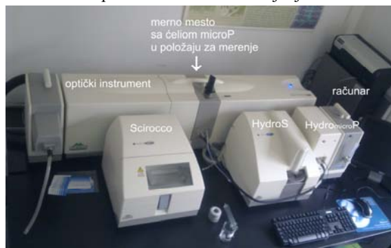
Slika 3 - Uređaj za LD analizu Mastersizer 2000, Malvern Instruments, UK: optički instrument i merne ćelije Scirocco, HydroS i Hydro \mu P
