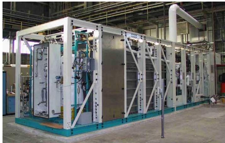
Slika 14. Siemens Westinghouse 250 kW SOFC, najveći sistem na svetu.
