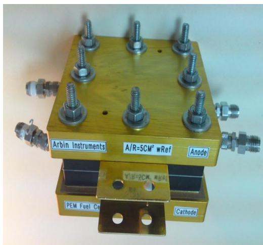
Slika 28. Arbin Instruments konstrukcija PEMFC od 5 \text{ cm}^2 -levo; izgled monopolarne ploče sa kanalima za prolaz gasova- desno.
