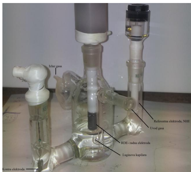
Slika 27. Izgled elektrohemijske ćelije
