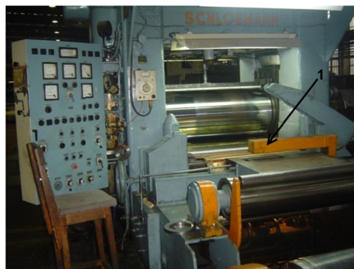
Fig. 1. Duo Rolling mill: 1) 90 Sr gauge
