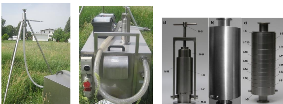
Slika 1. Kaskadni impaktor niskog pritiska Prof. Dr. Berner – LPI 25/0,0085/2 (levo) sa ISAP vakuum pumpa (sredina) i presa za montiranje (desno): a) osnovna ploča poluge (M-G), okvir (M-B), zavrtanj kompresije (M-S), matica (M-H), omotač impaktora (J-G), brava (I-V), b) impaktor sa omotačem spreman za upotrebu, c) niz faza impaktora, baza impaktora sa ispusnom ivicom i koordinantnom prskalicom (I-B), ulazni stalak impaktora (I-E), stalci impaktora (I-T1 do I-T11) ( https://www.isap.com ).
