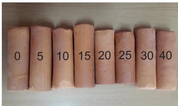
Slika 1. Opeka sa fosfogipsom u rasponu od 0 – 40 %, pečena na 1000\text{ }^{\circ}\text{C} [24].
