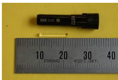
Slika 1. RPLD: zaštitna plastična kapsula sa ID brojem i staklena šipka.
