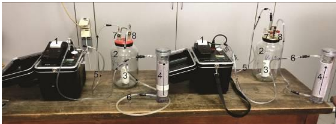
Slika 1. (1) Alfa spektrometar RAD7, (2) komora od debelog stakla sa metalnim zatvaračem, (3) uzorak, (4) apsorber vlage ( \text{CaSO}_4 ), (5) i (6) plastične cevi, (7) i (8) slavine za puštanje radonskog gasa iz komore u sistem.
