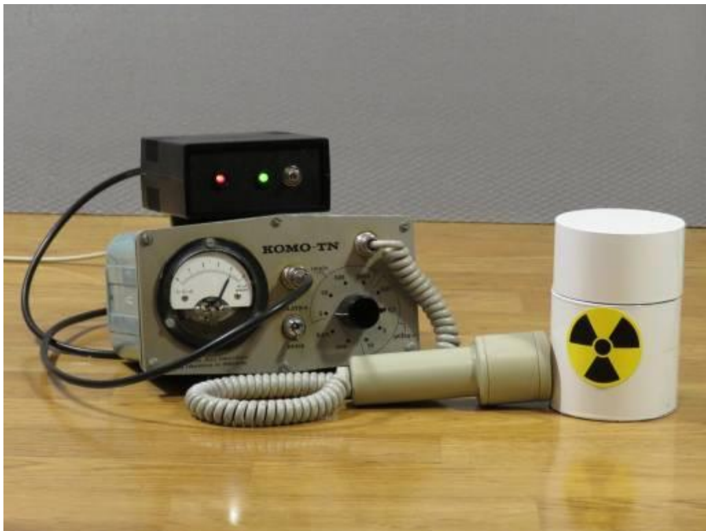
Slika 1. Primer korišćenja interfejsa za povezivanje merača KOMO-TN na računar.
