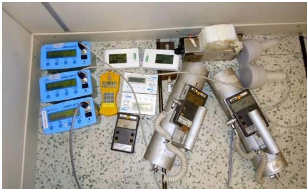
Slika 1. Dozimetri prilikom merenja unutar WBC čelične kabine.
