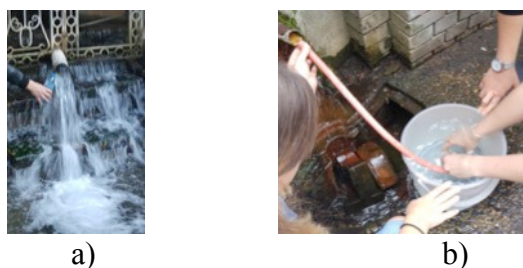
Slika 1. Dve tehnike uzimanja uzoraka vode za merenje radona (a) direktno punjenje boce, (b) posredno punjenje boce zaranjanjem u kofu koja se konstantno puni crevom
