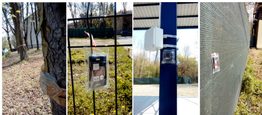
Slika 1. Različiti načini postavljanja TLD na platformi i van nje sa plastičnim zaštitama
