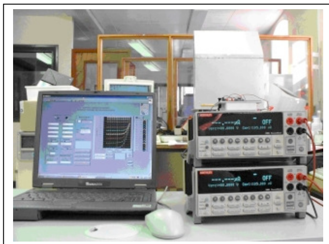
Slika 1. MESY2002: softverska podrška na laptopu, uređaj za test elektronskih komponenti, dva Keithley 2400 SourceMeter
