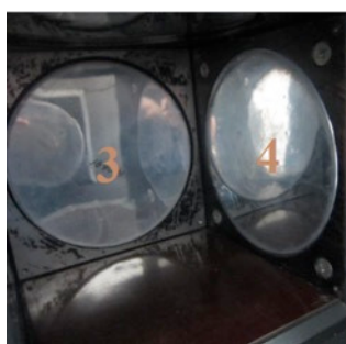
Slika 2. Detekciona komora i par detektora koji može da registruje dvostruku koincidenciju
