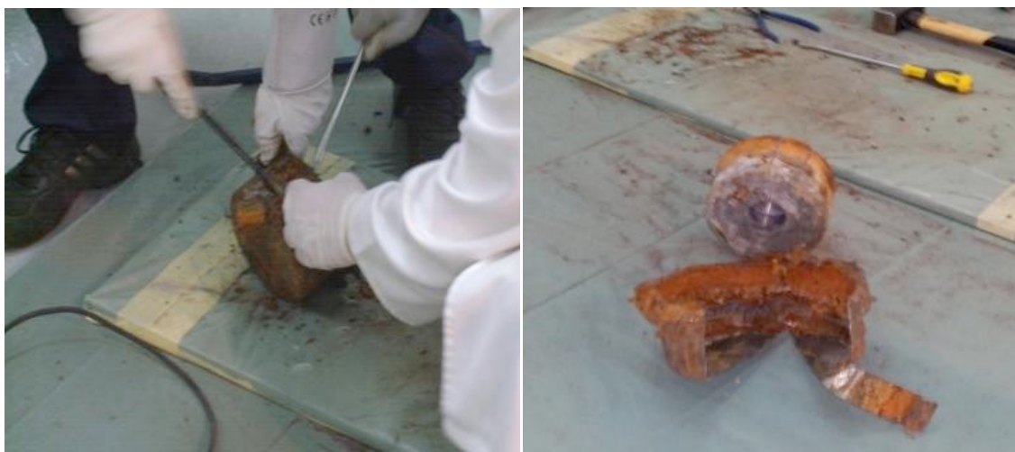
Slika 2. Vađenje radioaktivnog izvora iz gromobrana
