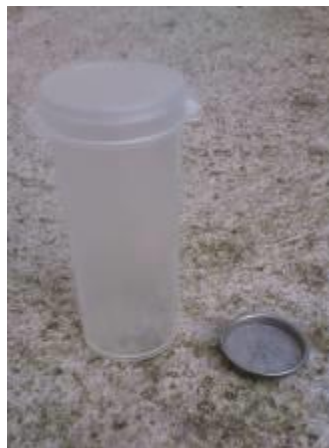
Slika 2. Geometrije merenja: fiola (levo) i planšeta (desno).
