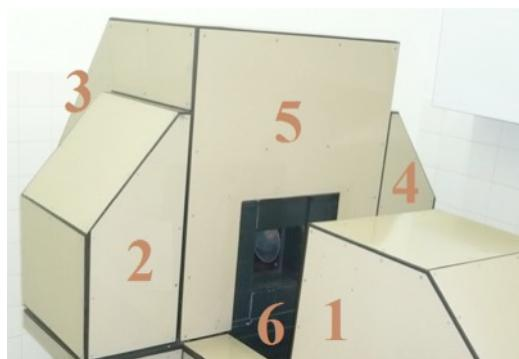
Slika 1. Detektorske jedinice spektrometra tipa PRIPJAT (PRIPJAT-2M)
