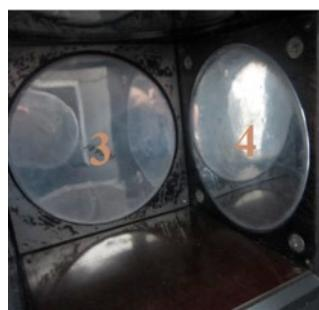
Slika 2. Detekciona komora i par detektora koji može da registruje dvostruku koincidenciju
