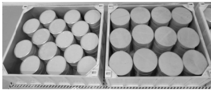
Slika 2 Način pakovanja buradi u ISO kontejnere
