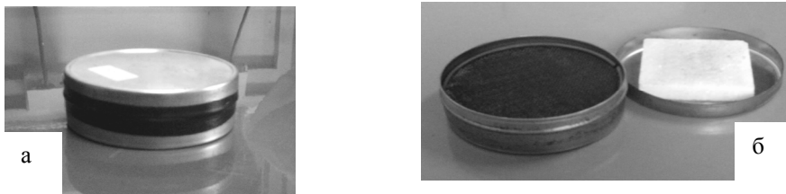
Слика 1. Затворени (а) и отворени (б) филтер са активним угљем
