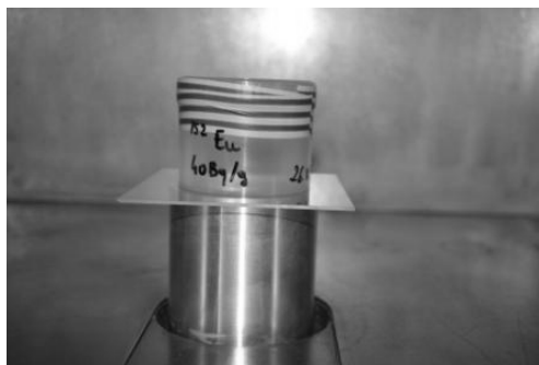
Slika 1. Geometrija plastične cilindrične kutijice sa apsorberom od pleksiglasa
