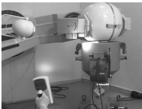
Slika 1. Dozimetrijska merenja prilikom instalacije izvora ^{60}\text{Co} aktivnosti 81.40 TBq iz uređaja za eksternu terapiju gama zračenjem
