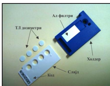
Slika 1. TL dozimetri tipa MTS-N pozicionirani unutar RADOS kućišta
