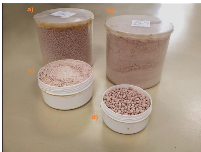
Slika 1. Izgled korišćenih geometrija merenja: a) Marineli posuda sa nesamlevenim uzorkom, b) Marineli posuda sa samlevenim uzorkom, c) cilindrična posuda od 250 cm 3 sa samlevenim uzorkom, d) cilindrična posuda od 125 cm 3 sa nesamlevenim uzorkom
