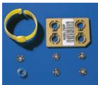
Slika 1. Dozimetri DXT-RAD (Thermo Scientific, USA),
