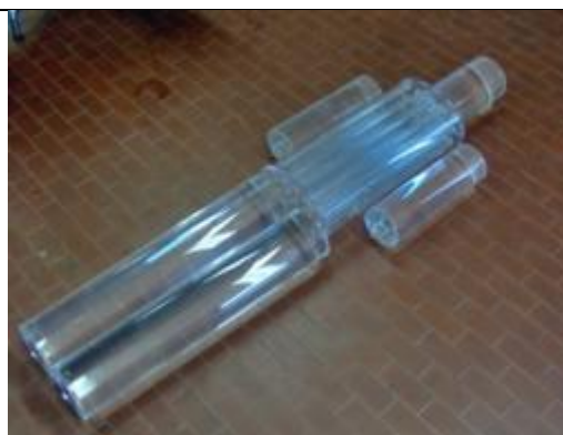
Slika 2. BOMAB fantom korišten u mjerenjima raspodjele doza za različite modalitete fotonske radioterapije u Pisi i Krakovu
