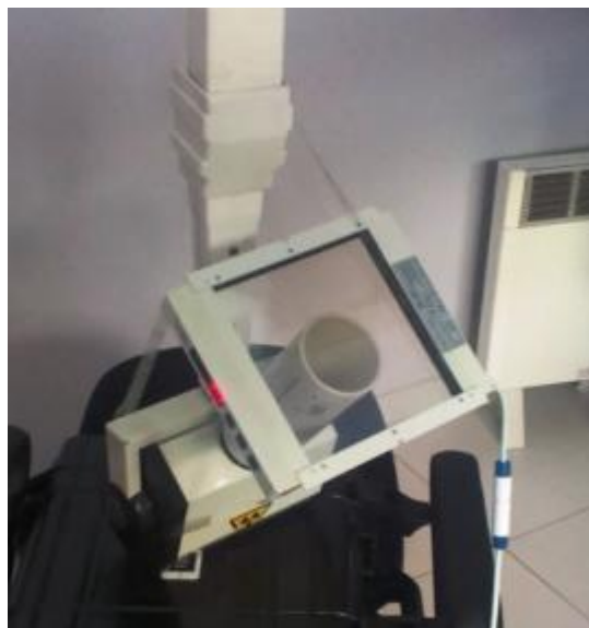
Slika 1. Pozicioniranje DAP detektora
