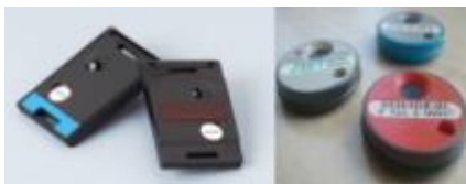
Slika 1. (Levo) VINCA dozimetri; (Desno) SCK-CEN dozimetri (preuzeto sa http://science.sckcen.be/en/Services/RDC/Dosimetry )
