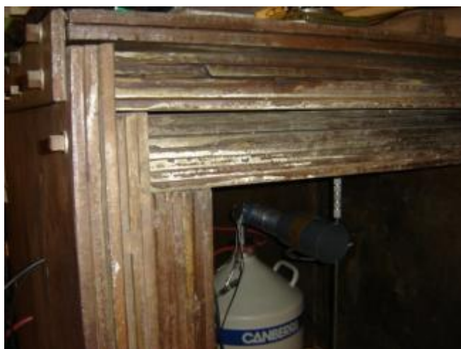
Слика 2. HPGe спектрометар произвођача Canberra у нискофонској заштити од гвожђа
