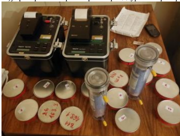
Слика 6. Експериментална поставка за контролу квалитета резултата мерења концентрације радона
