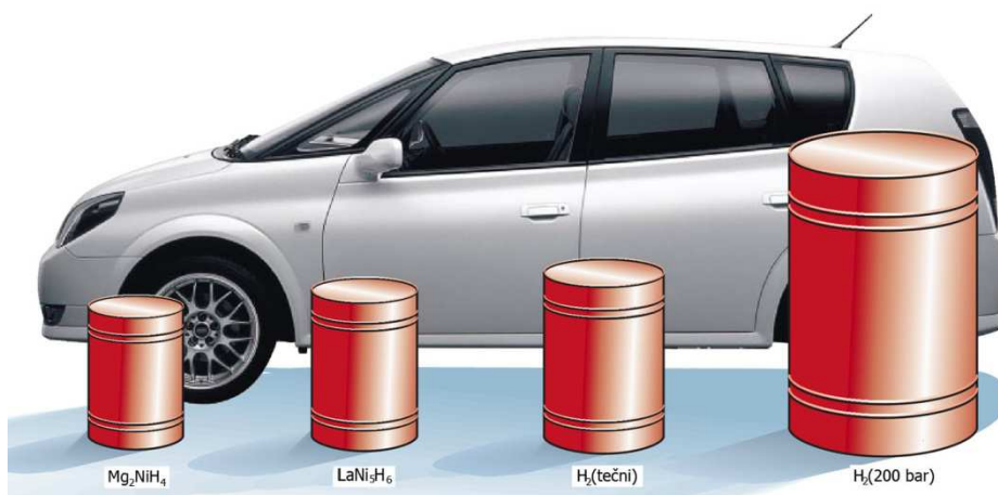
Slika 1.2. Zapremina 4kg vodonika uskladištena na različite načine u odnosu na veličinu automobila. Preuzeto uz dozvolu izdavača „Nature Publishing Group“: „Nature“, copyright (2001) [2].
