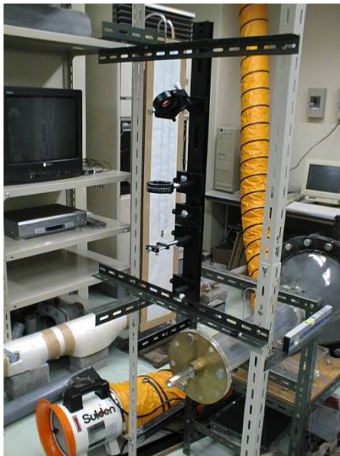
Slika 4-30 Optički set za kontrolu laserskog polja
