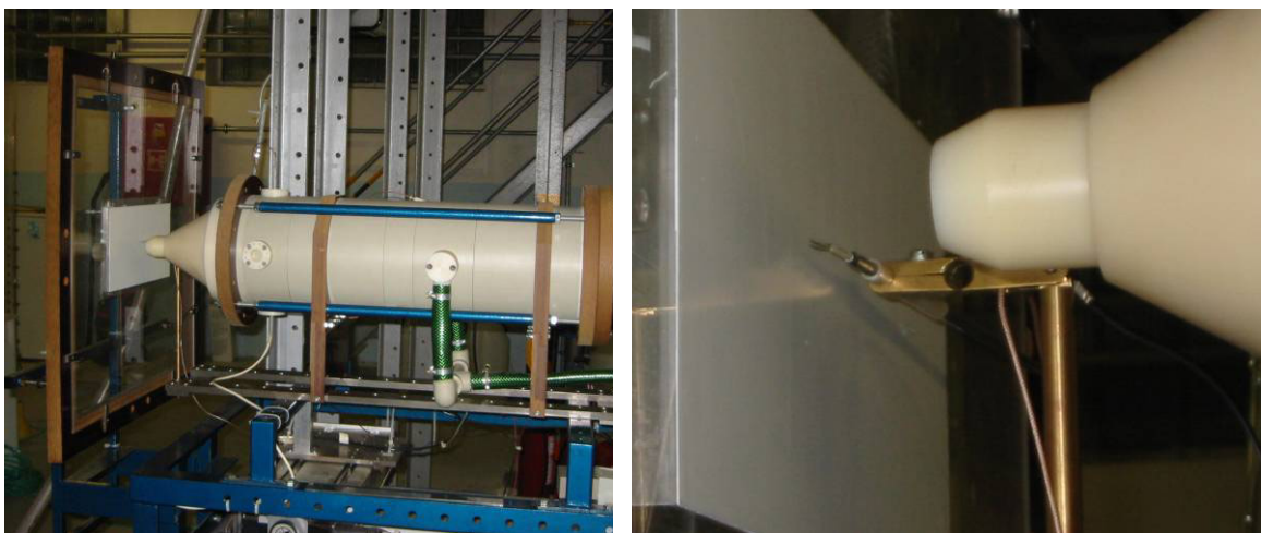
Slika 4-5 a) Eksperimentalna instalacija – ICPF Prag i b) Traverzni mehanizam za precizno pozicioniranje
