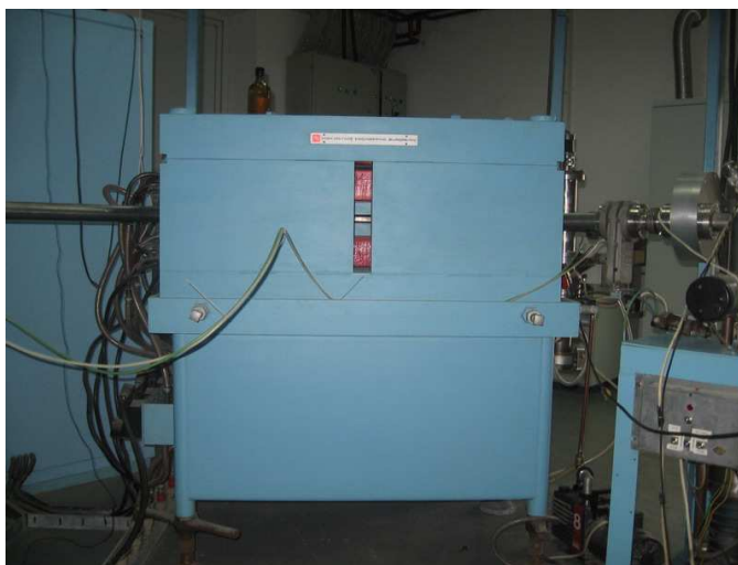
Слика 13. Магнет јонског имплантера
