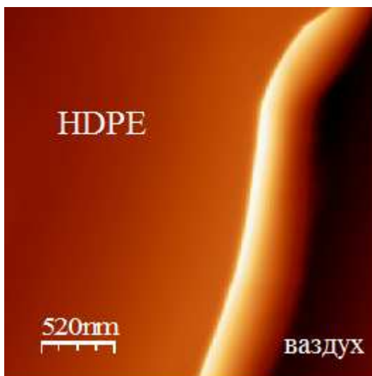
Слика 60. FMM попречни пресек HDPE имплантираног Au^+ јонима енергије 100 keV дозом од 5 \cdot 10^{15} јона/ cm^2 ( 2.6 \times 2.6 \mu m )
