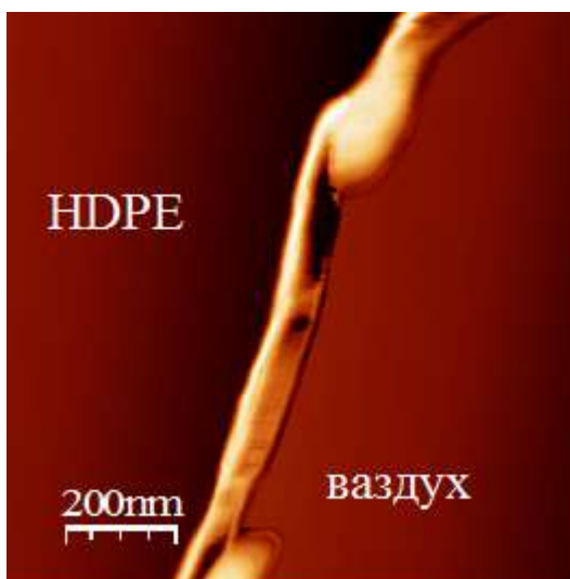
Слика 40. FMM попречног пресека HDPE имплантираног Ag^+ јонима енергије 60 keV дозом од 5 \cdot 10^{15} јона/ cm^2 ( 1 \times 1 \mu m )
