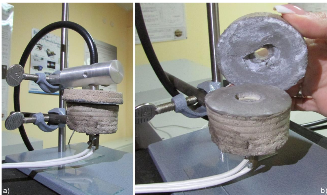
Slika 24. a) Peć za grejanje uzorka sa optičkim vlaknom postavljenim u položaj za merenje; b) unutrašnjost peći sa mestom predviđenim za postavljenje tabletiranog uzorka i termoparom
