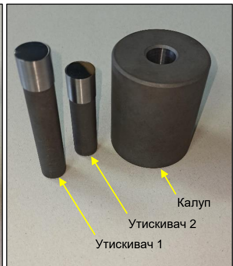
Слика 45. Алат за једноосно двострано компактирање праха МС
