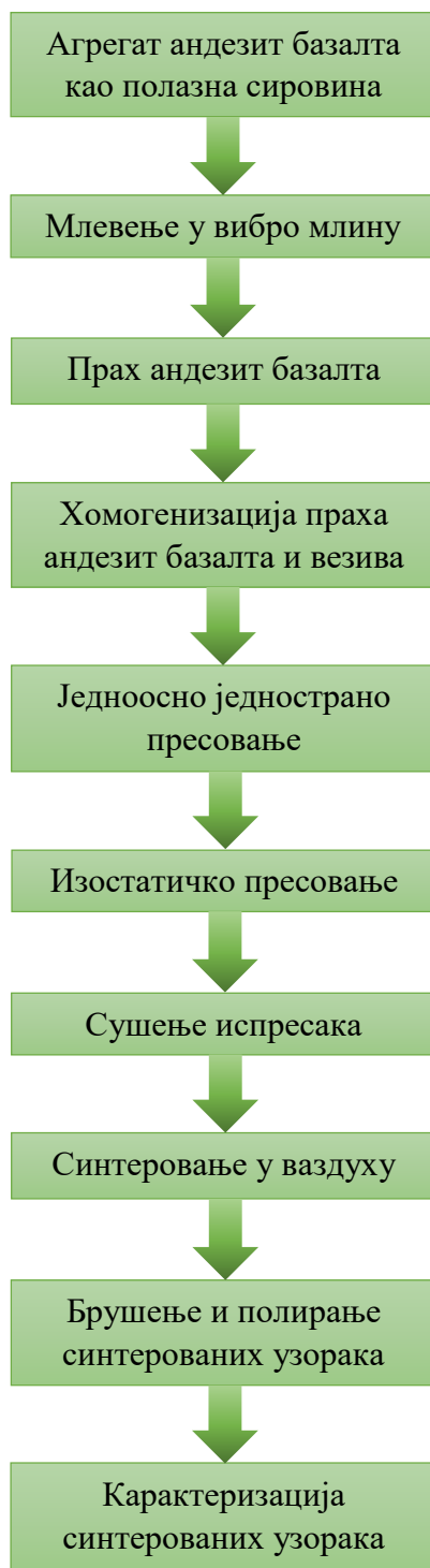
Слика 25. Шематски ток синтезе стакло-керамичких материјала
