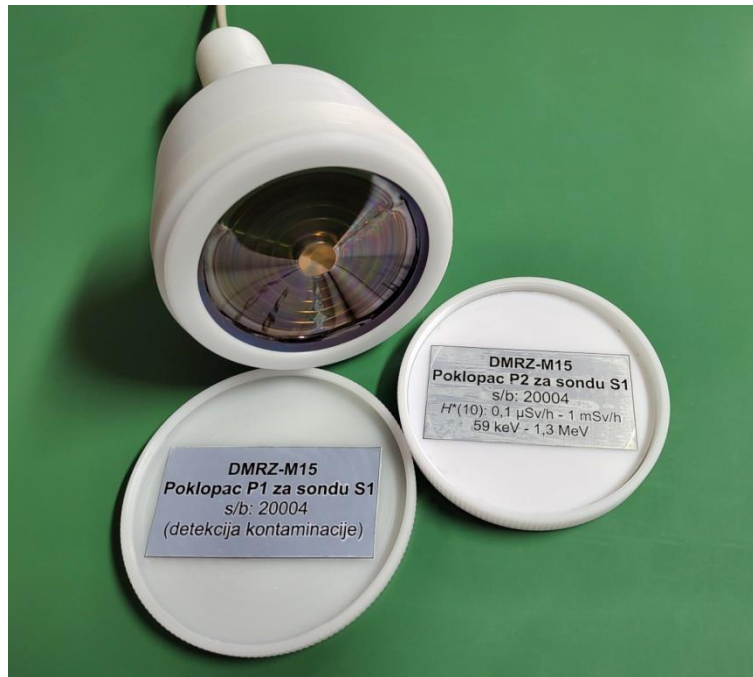
Slika 1. Sonda S1 sa skinutim poklopcem (vidi se prozor GM cevi) i poklopci P1 za detekciju kontaminacije i P2 za merenje jačine ambijentalnog ekvivalentnog doze
